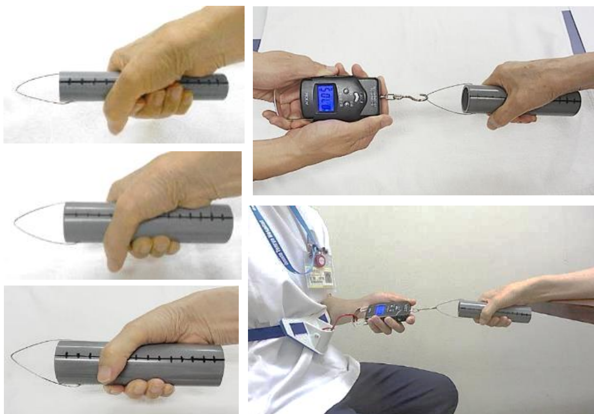
図1 市販の塩化ビニール管3種のサイズで把持力を測定
