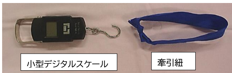
図2. 筋力測定は非伸縮性の牽引紐（測定部の大きさにより適切な幅を選ぶ）を介して器具のフックで牽引する。
